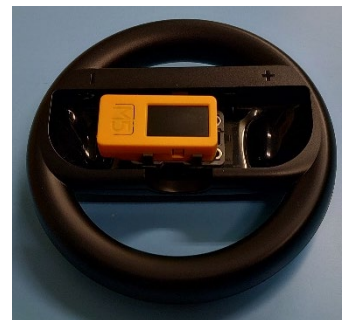
自作のハンドル型コントローラー (6軸IMU, Wifi通信, LCD表示)
